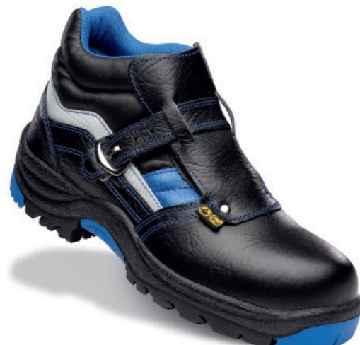
Bota de piel hidrofugada. Cierre con hebilla de desprendimiento rápido. Puntera no metálica Vincap. Plantilla antiperforación textil. Entresuela de poliuretano. Patín de caucho nitrilo con nivel de deslizamiento SRC.
