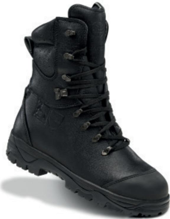
Bota de piel flor hidrofugada e ignífuga. Puntera metálica. Plantilla Antiperforación textil. Suela de caucho nitrilo ignífugo con nivel de deslizamiento SRC.
