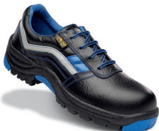
Zapato de piel hidrofugada. Puntera no metálica Vincap. Plantilla antiperforación textil. Entresuela de poliuretano. Patín de caucho nitrilo con nivel de deslizamiento SRC.
